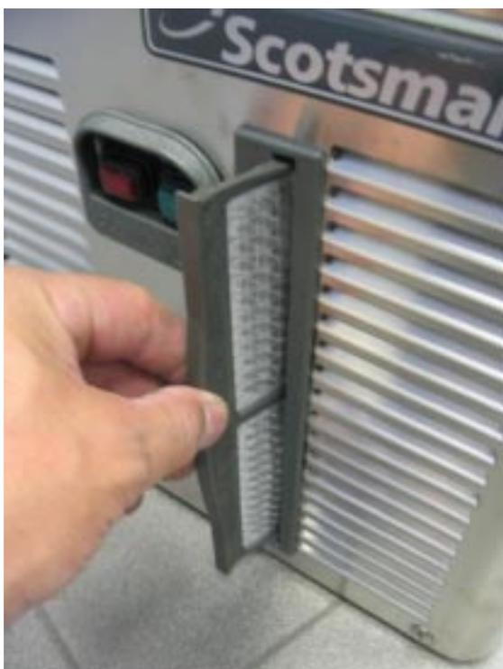
2. Souffler de l'air sous pression dans le sens opposé au flux d'air du condenseur pour enlever la poussière accumulée.
