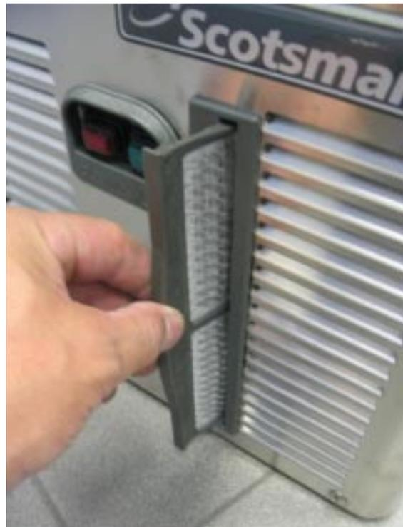
2. Souffler de l'air sous pression dans le sens opposé au flux d'air du condenseur pour enlever la poussière accumulée.
