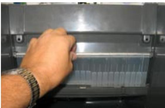
6. Levez la plaque d'arrosage de sa siège pour la nettoyer soigneusement à la main.
